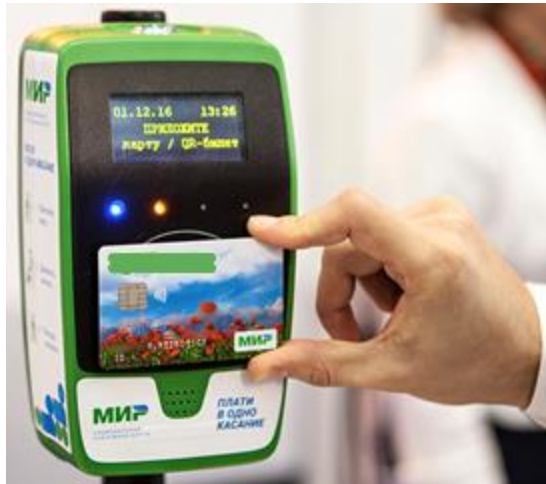
Автоматический валидатор общественного транспорта
